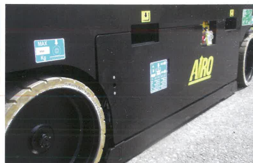
Sistema automatico anti-ribaltamento per traslazione dall'alto Automatic pot-hole guards for drive at max. height
