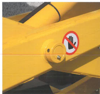
Boccole autolubrificanti dotate di ingrassatori esterni Self-lubricating bushings fitted with external greasers
