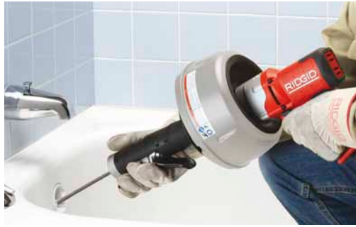
Το μοντέλο K-45AF αποφράσσει γρήγορα τις βουλωμένες αποχέτευσεις μπανιέρας. Προώθηση και απόσυρση σπирάλ χωρίς αντιστροφή του μοτέρ.
