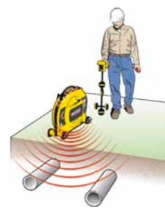
Επαγωγή σήματος για τον εντοπισμό εγκαταστάσεων
