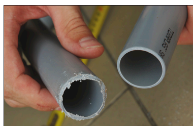
Κοπή με πριόνι (αριστερά) σε αντιδιαστολή με τον P-TEC 3240 (δεξιά).
