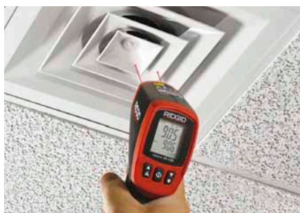
Μέτρηση της αποτελεσματικότητας της απαγωγής της θερμότητας για να αποκαλυφθούν και να εντοπιστούν οι θερμικές απώλειες στα συστήματα ροής
