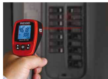
Έλεγχος ασφαλειών ή ασφαλειοδιακοπών για υπερθέρμανση, που μπορεί να προκληθεί από υπερφορτωμένα κυκλώματα
