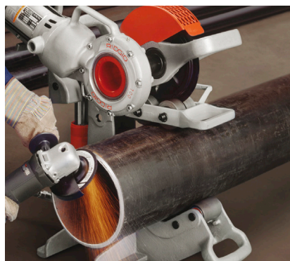
Χρήση του μοντέλου 258 με περιστροφέα σωλήνων για φρεζάρισμα. Για αυτή την εργασία συνιστώνται δύο άτομα
